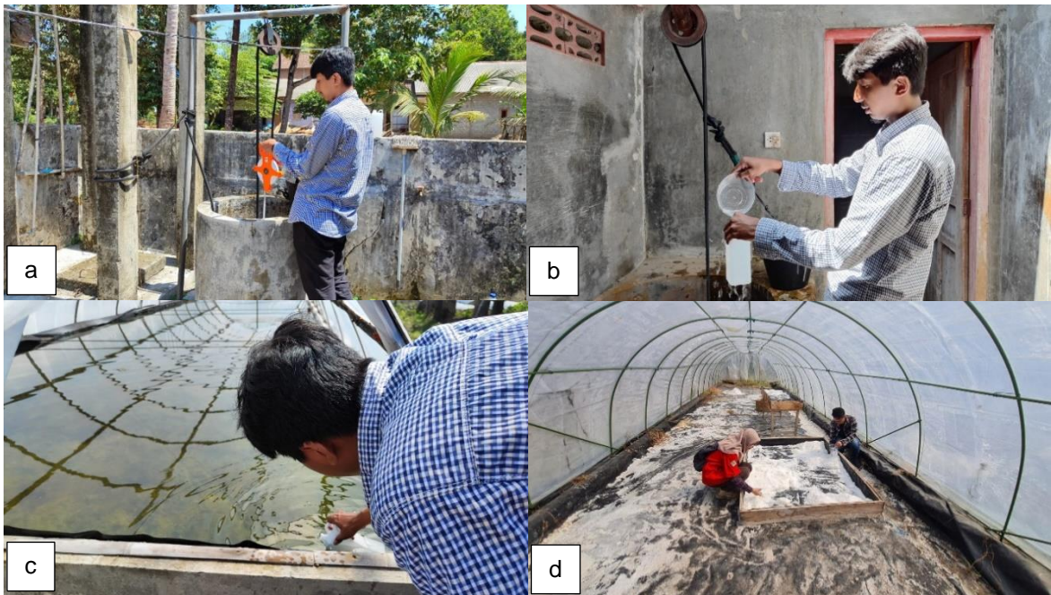
Gambar 1. Pengambilan data lapangan di daerah penelitian. a. Pengukuran kedalaman sumur warga dengan menggunakan meteran ukur. b. Pengambilan sampel air sumur warga. c. Pengambilan sampel air laut dari salah satu tunnel yang digunakan sebagai bahan baku pembuatan garam. d. Pengambilan sampel garam pada salah satu tunnel garam.
